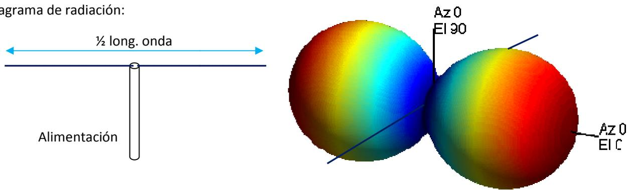
La radiación en este dipolo es perpendicular al plano que forma el hilo, e igual a ambos lados. En cambio hacia los extremos del dipolo presenta una atenuación.
